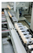
Links: Bearbeitungsaggregate mit Hauptspindel; rechts: Zangenwagen mit zwei Teile;
