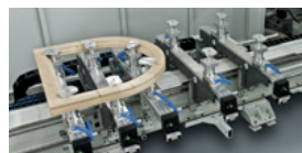
Rundbogenbearbeitung auf CNC-Konsolen.
